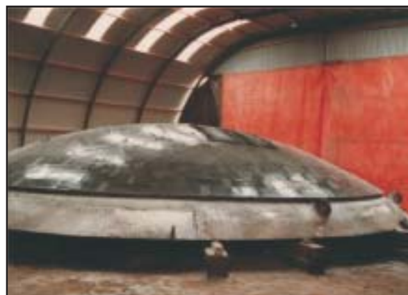
Slika 1: Polkalotte okruglog spremnika bandažiranog LUCOBITOM®
